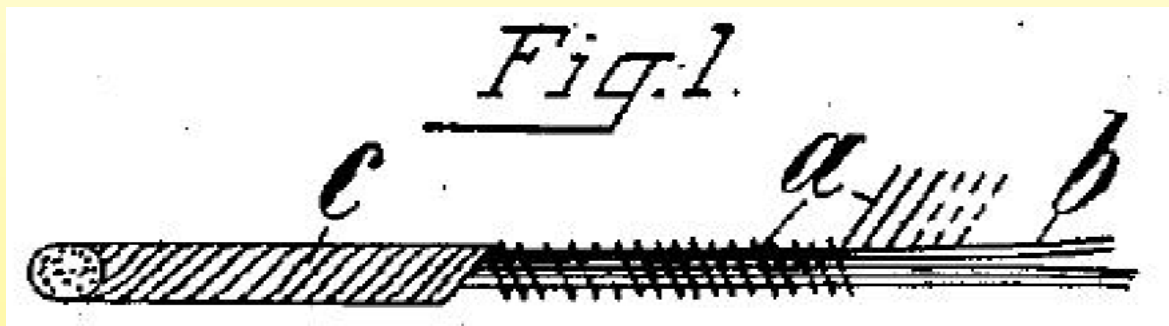
Нагревательный шнур (запатентован Камилем Эррготтом, 1901 г.). А = нагревательный провод; В = текстильный сердечник; С = внешняя обмотка, намотанная в противоположном направлении от нагревательного провода
