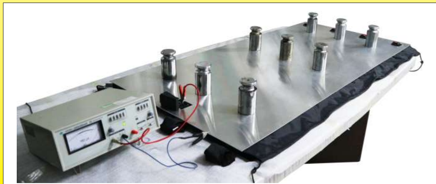
Прибор для измерения сопротивления изоляции. Измеренные значения всегда больше 0,1 ГОм
