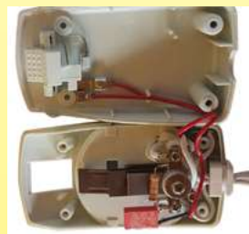
1995: Американское нагревательное одеяло с электросчетчиком, аналогичное разработанному более чем за 50 лет до этого Куком в 1942 году. Внешний вид и вид внутреннего биметалла демонстрирует медленный расцепитель с предполагаемым сопротивлением. Единственным примечательным новшеством в этой модели является наличие фильтра шумоподавления (Коллекция Ultimheat)
