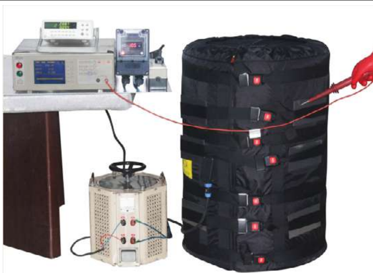
Измерительное оборудование для измерения полного тока утечки в горячем состоянии
