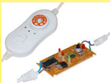
2019 Блок управления одеялом с непрерывным электронным управлением мощностью (коллекция Ultimheat)
