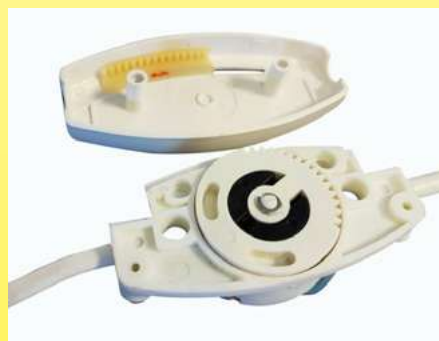
3-позиционный переключатель нагрева и 2-позиционный стоп-переключатель на нагревательном одеяле. Промежуточная модель между вращающимися системами и ползунковыми системами (1970 г., коллекция Gitem Ultimheat)
