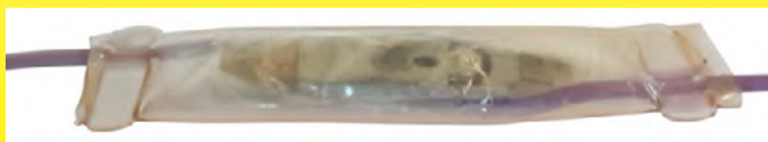
Ограничитель температуры нагревательного одеяла с медленным разрывом, используется в сочетании с английской системой управления мощностью производства GEC (General Electric Company). Он покрыт водонепроницаемой PVC втулкой, приваренной к проводам. Около 1970 года (Коллекция Ultiheat)
