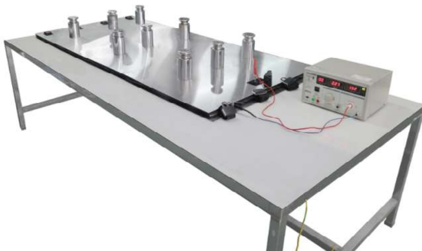
Измерительное оборудование для измерения полного тока утечки в холодном состоянии
