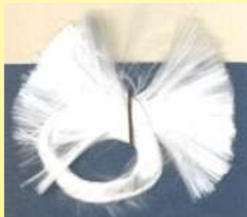
Пучки нитей стеклянной нити, образующие единый провод (Производство стеклянной нити, около 1960 года, урок в текстильной школе Вервье в Бельгии, музей Ultimheat)
