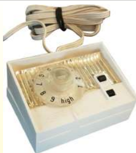
1970 г. Настройка мощности GEC (General Electric, Англия) на английском нагревательном одеяле. Предполагаемое сопротивление четко видно над биметаллическим и медленным прерывателем (коллекция Ultimheat).
